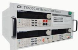
Système de cyclage (charge/décharge) de batterie :
